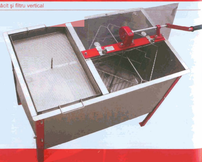
Centrifugă miere, cu tavă de descăpăcit și filtru vertical
