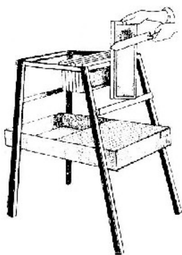
Fig. 141 Suport și cuțit electric pentru descăpăcire
