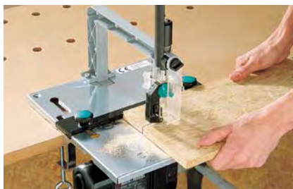
precizie - fără deviație laterală a pânzei de fierăstrău pendular
