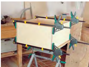
distanțiere glisante care protejează menghina, folosesc și ca suport
