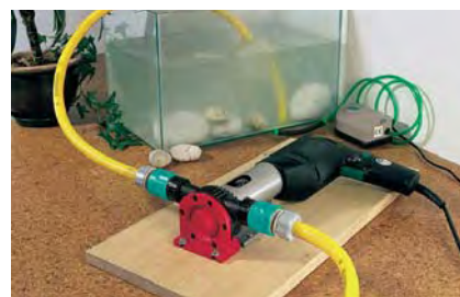
varianta noastră: pompa, mașina de găurit și scândura
