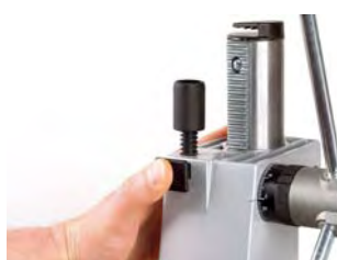
reglarea adâncimii de găurire prin opritor de profunzime cu reglaj rapid
