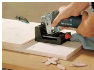
îmbinare cu plăcuțe de îmbinare
