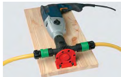
varianta noastră: pompa, mașina de găurit și scândura
