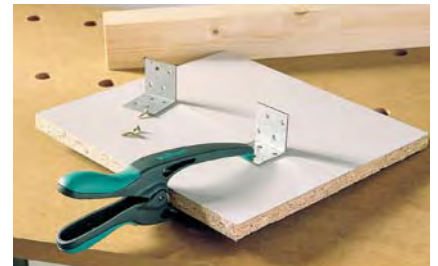
adâncime mare de prindere, pot fi fixate piese la distanță mare de margine
