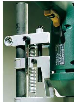
reglarea adâncimii găurii prin opritoarele de profunzime
