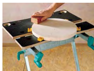
4 bacuri din material plastic pentru prinderi plane
