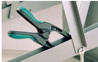
brațele ascuțite lungi, permit prinderea pieselor aflate în spații înguste
