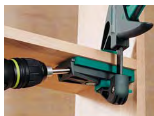
Cu undercover jig dați găuri precise în piesă
