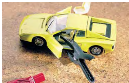
brațe lungi de prindere, ideal pentru locurile greu accesibile
