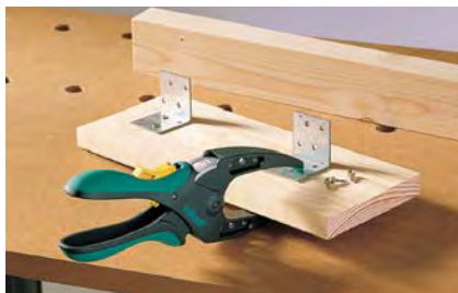
falca mare al menghinei permite fixarea pieselor la distanță mare de margine
